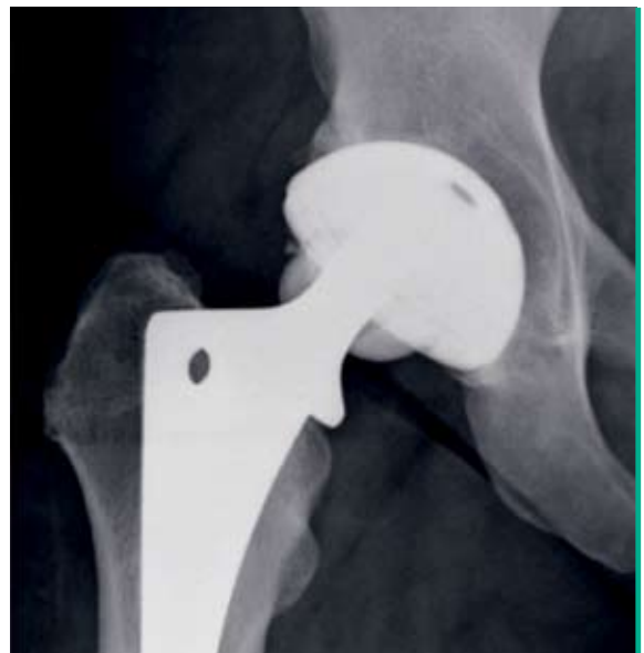
Abb. 3: Röntgenbild einer zementfreien Hüftprothese mit Keramik-Kopf. Der Kopf ist geborsten. Die Hauptfragmente sind erkennbar, das Splittermehl entzieht sich der Darstellung.
